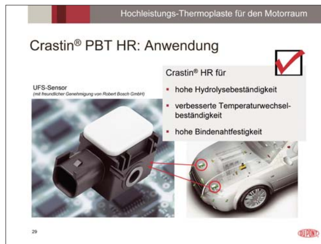
Bild 18. Anwendung eines Crastin® HR-Typs im Motorraum
