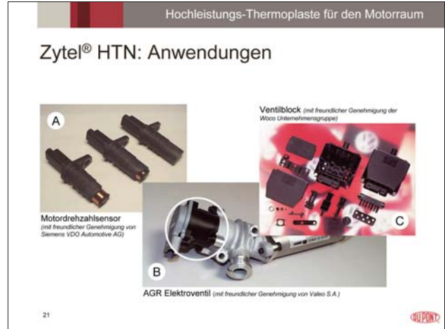
Bild 10. Anwendungen von Zytel® HTN im Motorraum
